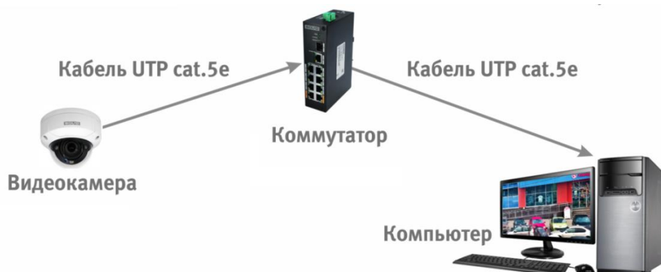
Рисунок 6.3 – Схема подключения видеокамеры к компьютеру через коммутатор
