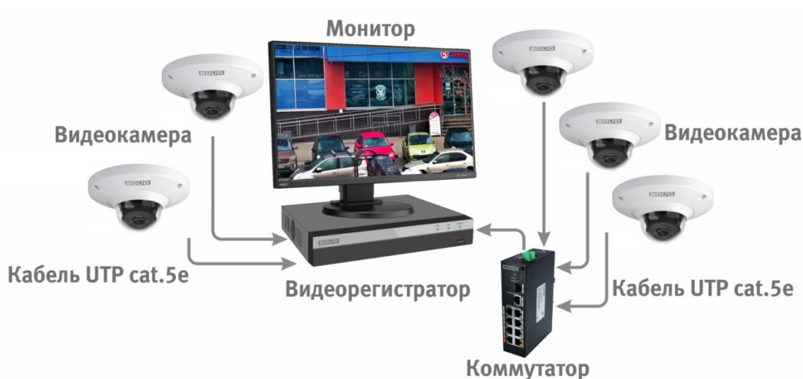
Рисунок 6.4 – Схема подключения видеокамеры к видеорегистратору
