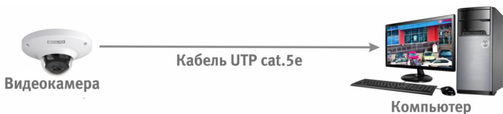
Рисунок 6.2 – Схема подключения видеокамеры к компьютеру
