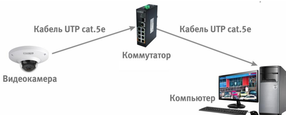
Рисунок 6.3 – Схема подключения видеокамеры к компьютеру через коммутатор
