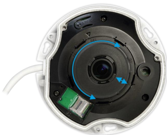
Рисунок 5.4 – Настройка направления объектива
