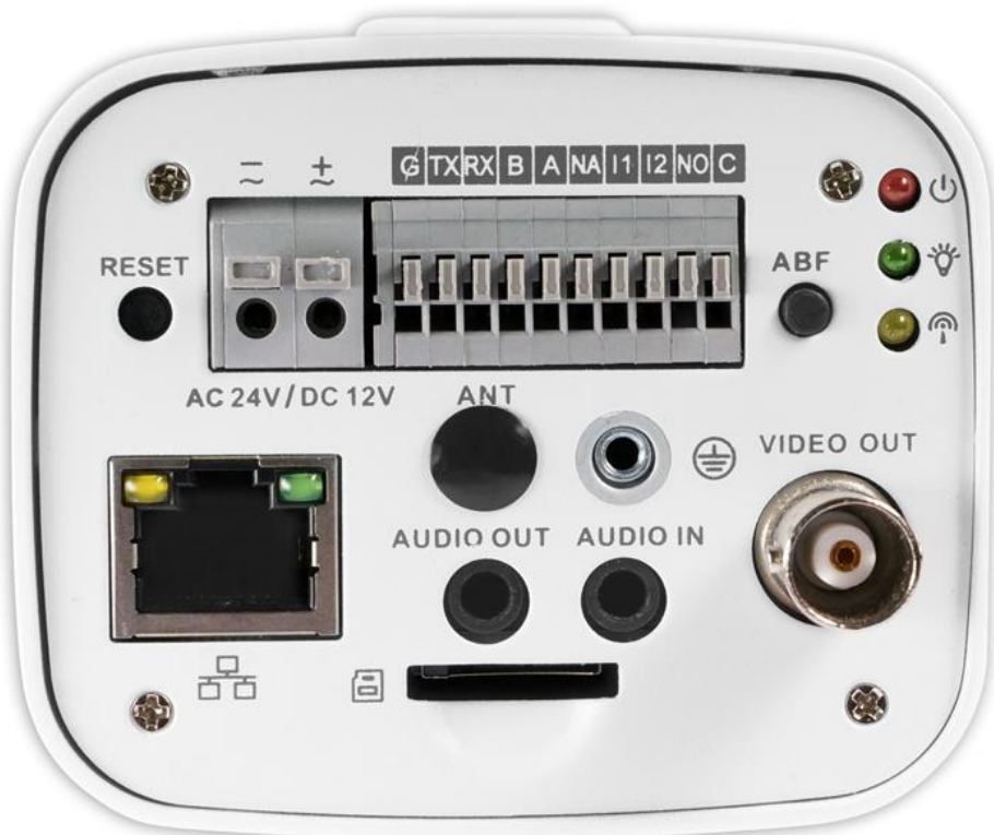
Рисунок 8.1 – Задняя панель видекамеры
