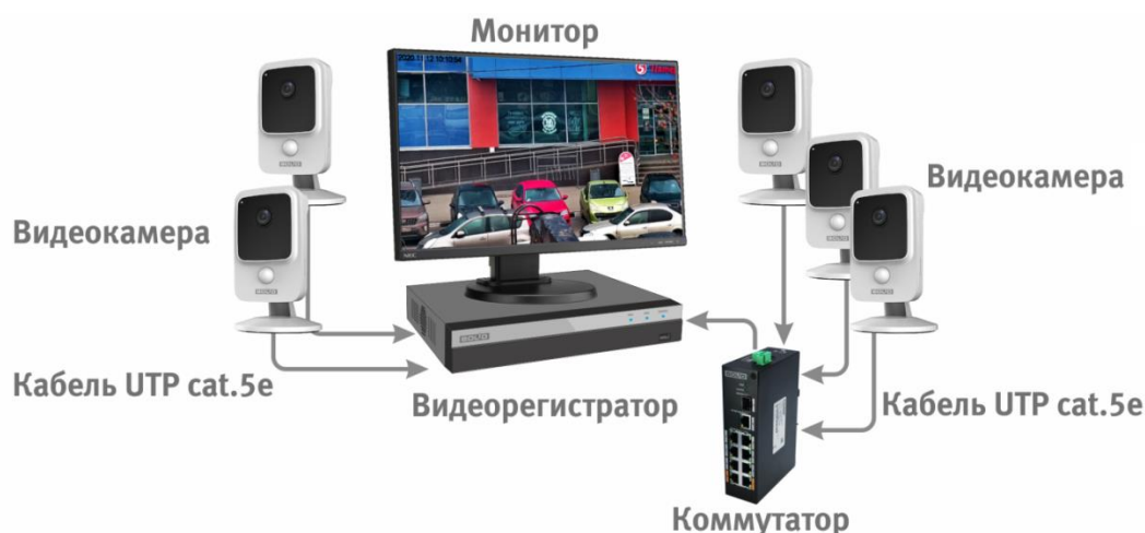
Рисунок 6.4 – Схема подключения видеокamеры к видеорегистратору
