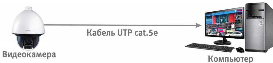
Рисунок 6.2 – Схема подключения видеокамеры к компьютеру
