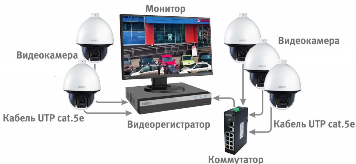
Рисунок 6.4 – Схема подключения видеокмеры к видеорегистратору
