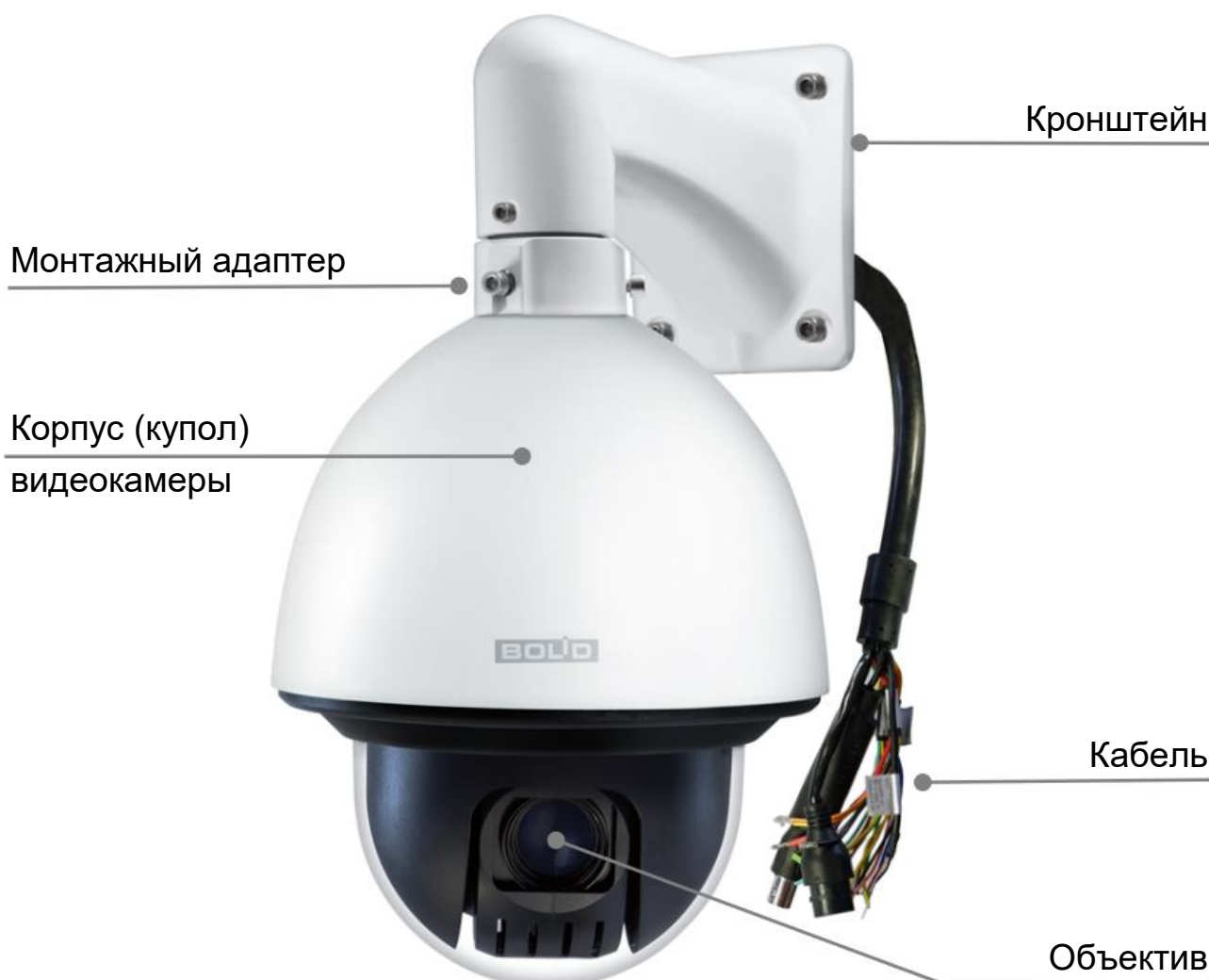
Рисунок 4.1 – Внешний вид и основные элементы видеокамеры
