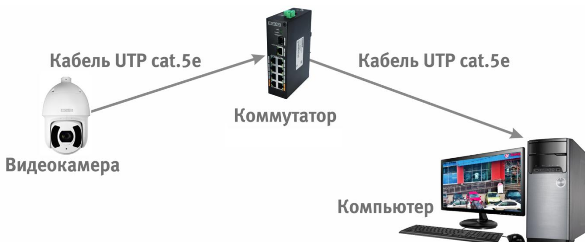
Рисунок 6.3 – Схема подключения видеокмеры к компьютеру через коммутатор
