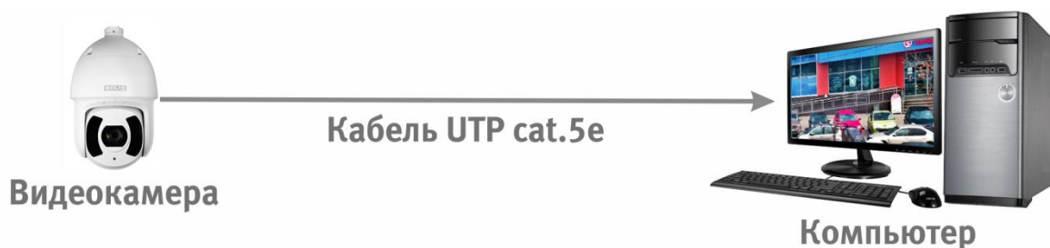
Рисунок 6.2 – Схема подключения видеокамеры к компьютеру
