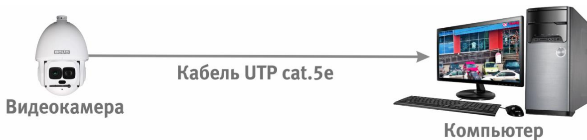
Рисунок 6.2 – Схема подключения видеокамеры к компьютеру
