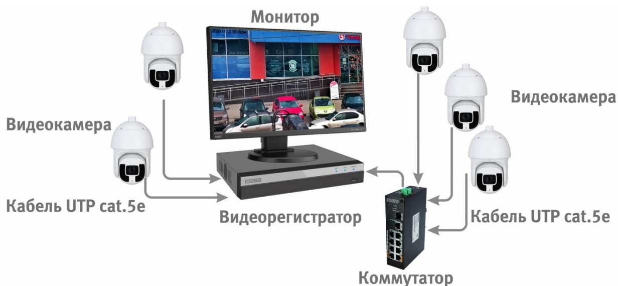
Рисунок 6.4 – Схема подключения видеокамеры к видеорегистратору
