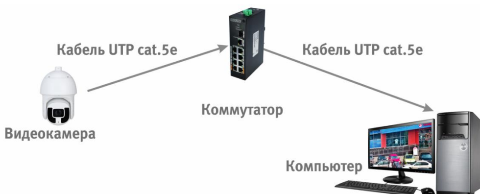
Рисунок 6.3 – Схема подключения видеокамеры к компьютеру через коммутатор
