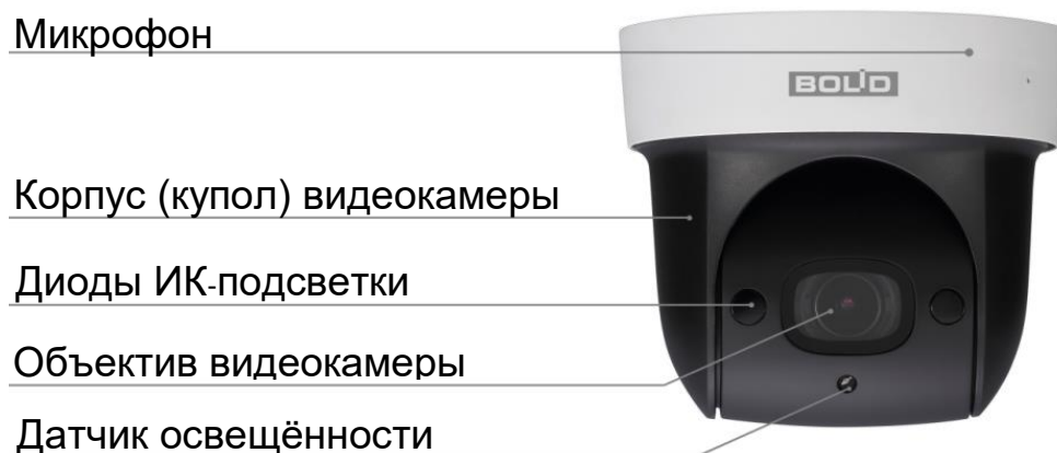
Рисунок 4.1 – Внешний вид и основные элементы видеокамеры
