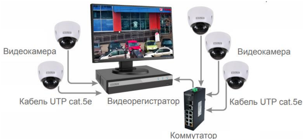
Рисунок 6.4 – Схема подключения видеокмеры к видеорегистратору
