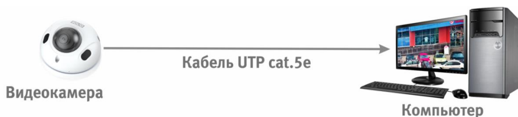
Рисунок 6.2 – Схема подключения видеокамеры к компьютеру
