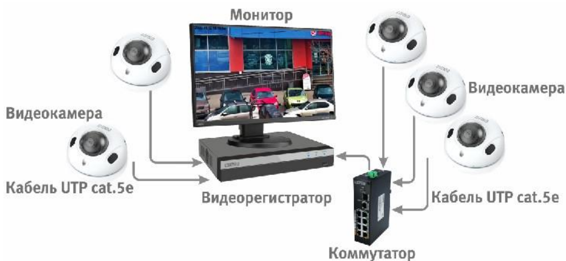
Рисунок 6.4 – Схема подключения видеокамеры к видеорегистратору
