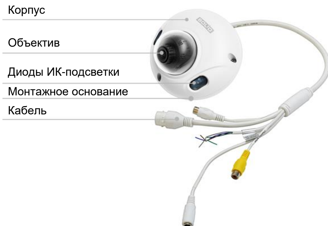
Рисунок 4.1 – Внешний вид и основные элементы видеокамеры
