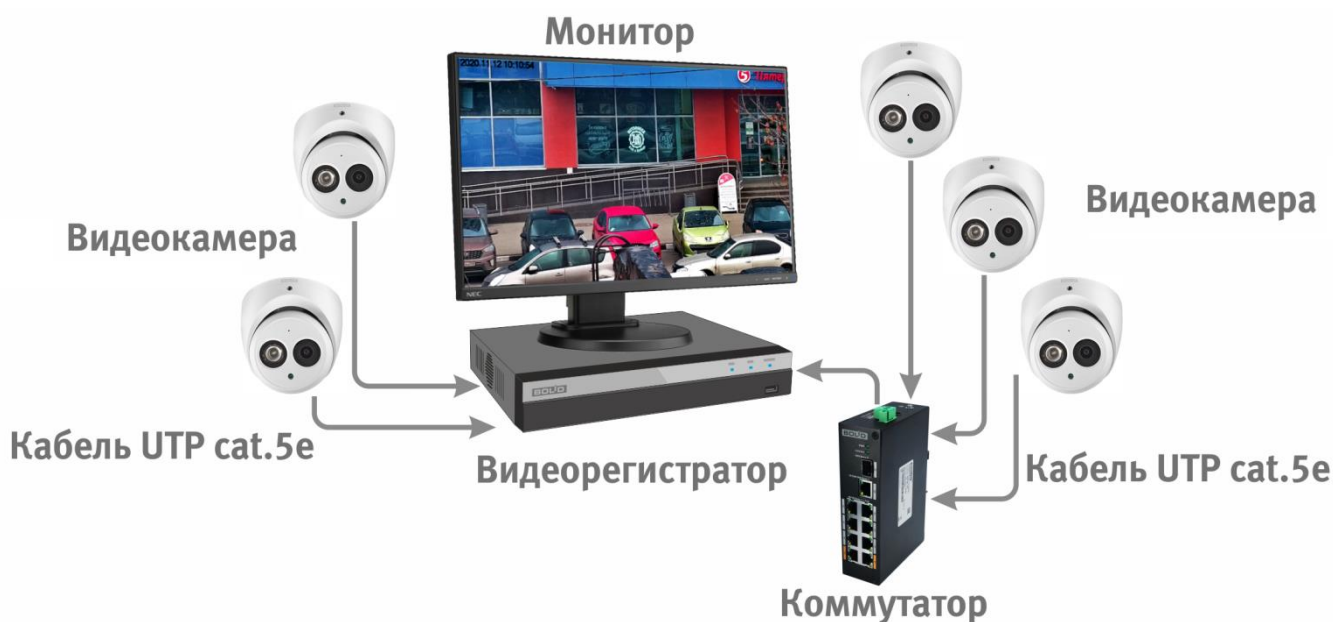
Рисунок 6.4 – Схема подключения видеокamеры к видеорегистратору
