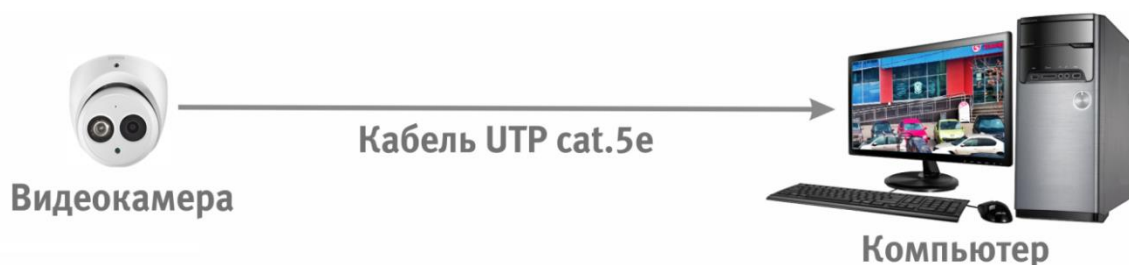
Рисунок 6.2 – Схема подключения видеокамеры к компьютеру
