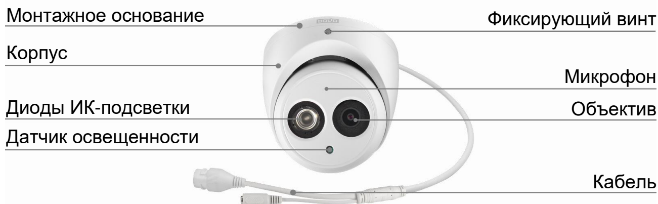
Рисунок 4.1 – Внешний вид и основные элементы видеокамеры
