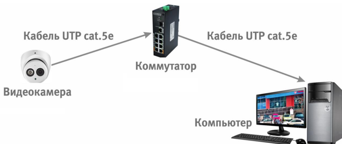
Рисунок 6.3 – Схема подключения видеокамеры к компьютеру через коммутатор
