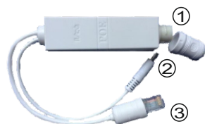
1- Вход LAN+PoE (RJ-45) 2- Выход 12 Вольт (питание видеокamеры) 3- Выход LAN (RJ-45)
