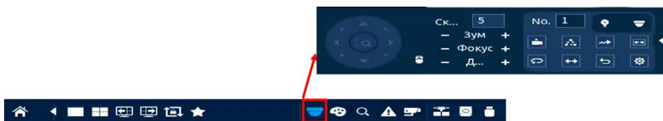
Рисунок 9.1 – Переход в меню PTZ-управления через панель навигации
