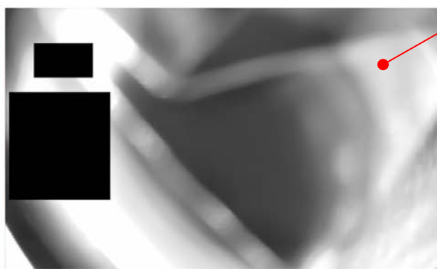
Рисунок 12.9 – Наложение частных зон на видеопоток
