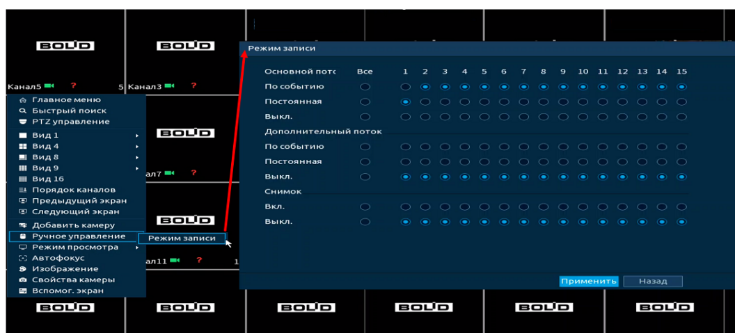
Рисунок 14.15 – Интерфейс настройки записи
