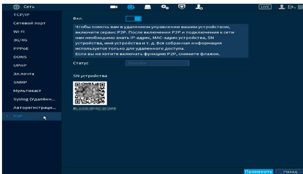
Рисунок 12.15 – Интерфейс включения «P2P»
