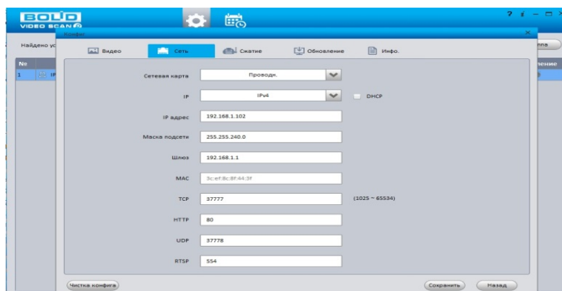
Рисунок 25.2 – Изменение IP-адреса с помощью утилиты «BOLID VideoScan»
