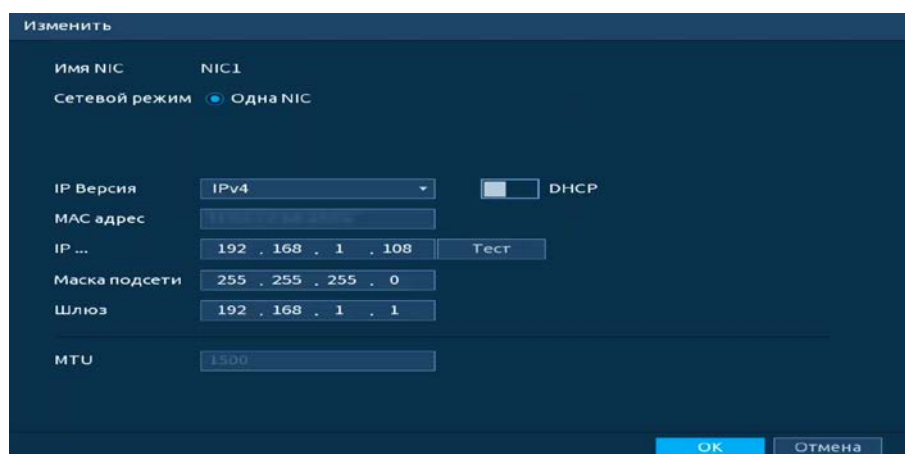
Рисунок 6.9 – Интерфейс меню быстрой настройки «Сеть»
