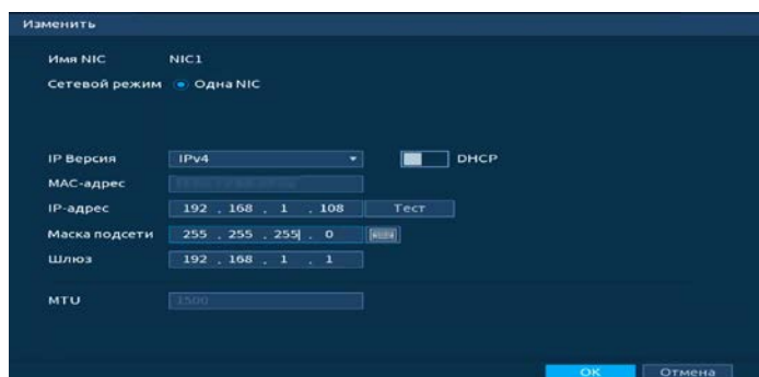
Рисунок 13.2 – Интерфейс настройки «Сеть»
