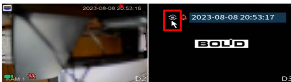
Рисунок 24.12 – Приостановка постоянного обхода
