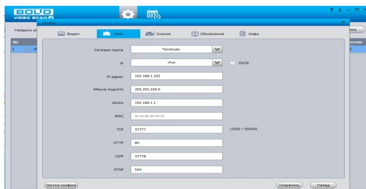
Рисунок 30.2 – Изменение IP-адреса с помощью утилиты «BOLID VideoScan»
