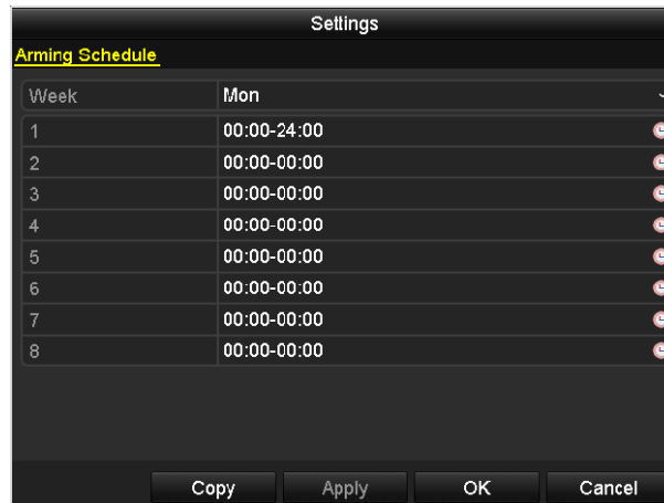
Рисунок 8-20 Установка расписания постановки на охрану тревожного выхода
