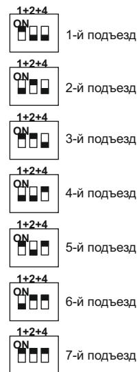
Рисунок 5 - Положение переключателей ПОДЪЕЗД в зависимости от номера подъезда
