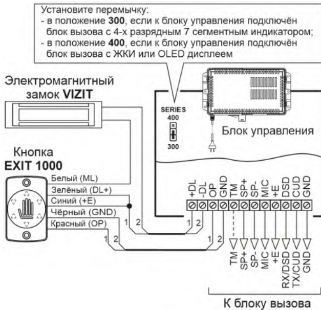
Рисунок 11.1 – Схема соединений блока управления, блока вызова, электромагнитного замка и кнопки EXIT 1000
