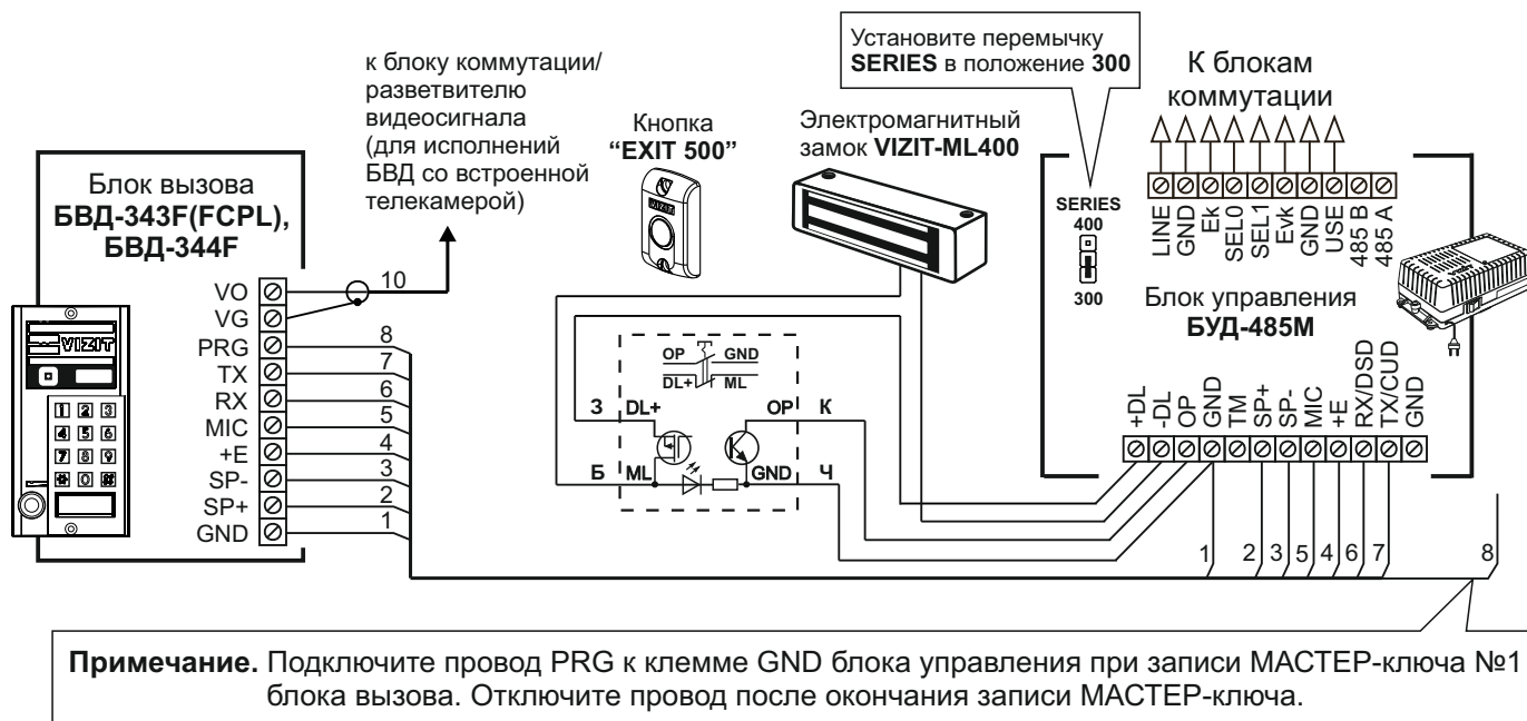
Рисунок 2 - Схема соединений блока вызова БВД-343F(FCPL), БВД-344F с блоком управления БУД-485М , электромагнитным замком VIZIT-ML400 и кнопкой "EXIT 500"
