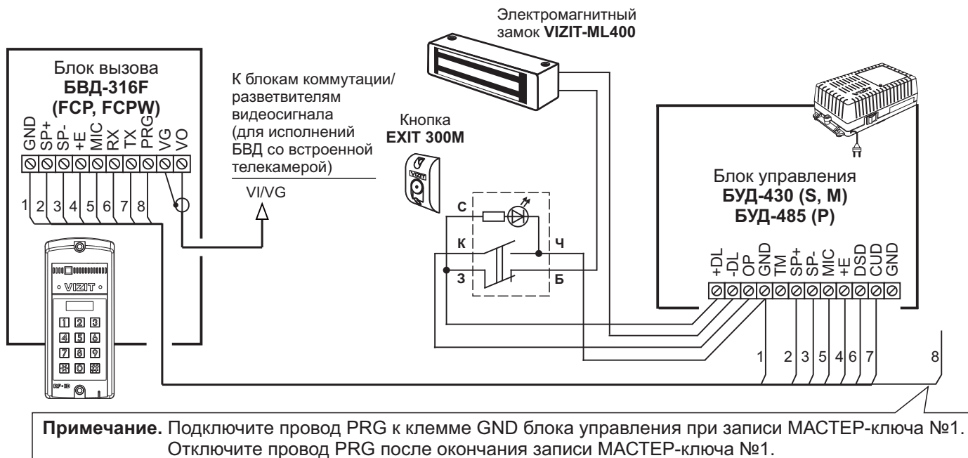
Рисунок 9 - Схема соединений блока вызова БВД-316F(FCP, FCPW) с блоками управления БУД-430 (S, M) , БУД-485 (P) , электромагнитным замком VIZIT-ML400 и кнопкой EXIT 300M
