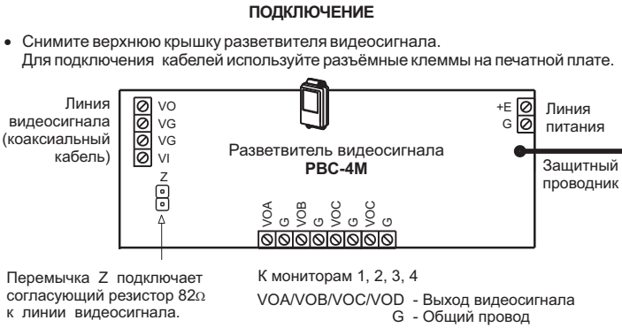
Рисунок 1 - Расположение клемм, назначение цепей и перемычек
