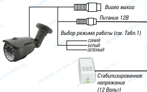
Рис.1 Схема подключения
