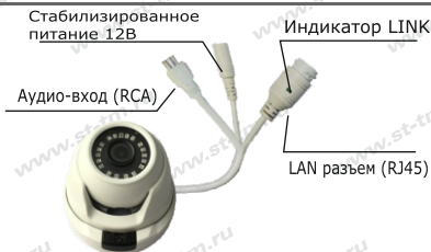
Рис. 1 Схема подключения видеокамеры
