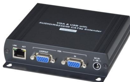
Рис.1 Передатчик VKM04T (вид спереди)
