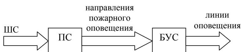
Рисунок 6.6. Сущности пожарного оповещения.
