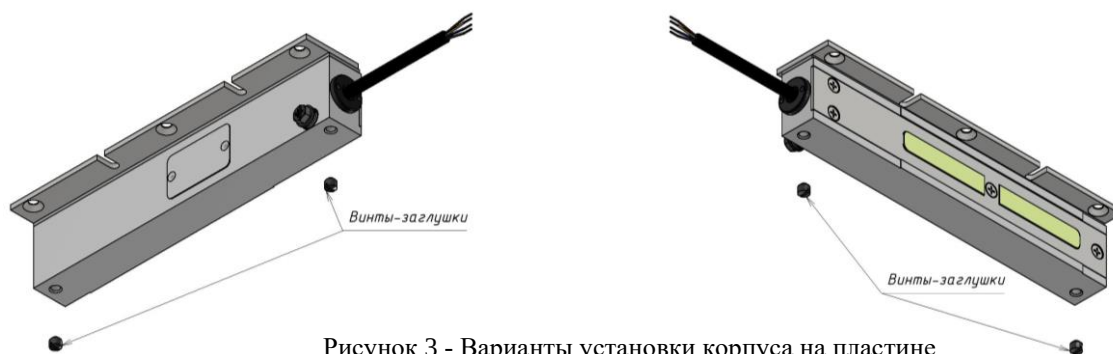
Рисунок 3 - Варианты установки корпуса на пластине
