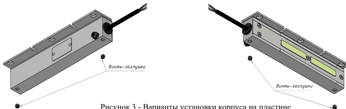
Рисунок 3 - Варианты установки корпуса на пластине
