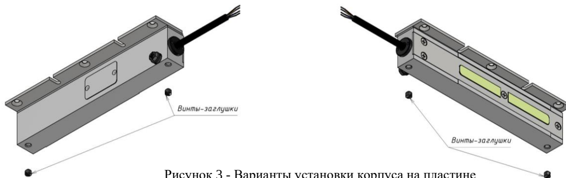
Рисунок 3 - Варианты установки корпуса на пластине
