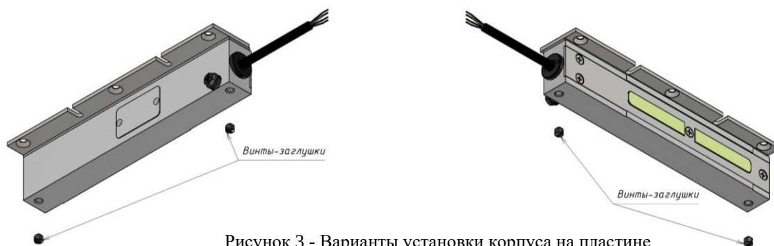
Рисунок 3 - Варианты установки корпуса на пластине
