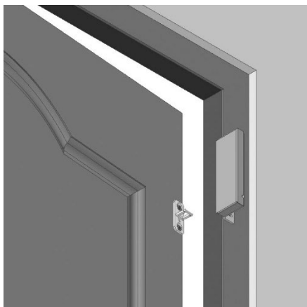
Рисунок 3- Установка замка на монтажный L-уголок
